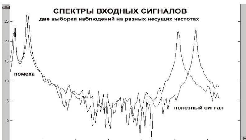
Рис. 5 Спектральное представление сигналов дискретной двухкомпонентной помехи с доплеровскими частотами компонент 10 Гц и 20 Гц и полезного сигнала с доплеровской частотой 200 Гц на входе. Амплитуды спектра в децибелах (dB), частота  $F$  в герцах с метками через 40 Гц. Две выборки на разных несущих частотах 500 МГц и 550 МГц
