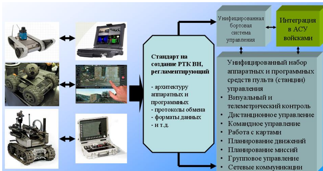
Рис. 3. Технология создания комплекса аппаратных и программных средств универсального переносного портативного терминала оператора
