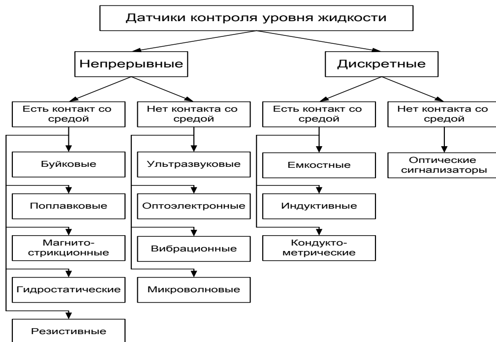
Рис. 1. Классификация уровнемеров по принципу метода измерения и по наличию контакта с измеряемой средой.
