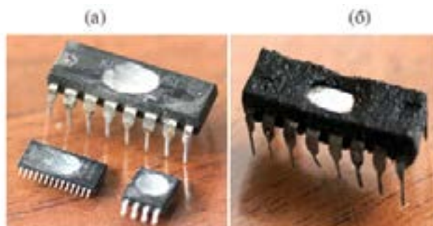
Рис. 5. Реинжиниринг макротопологии изделий корпусных ИМС: а – механообработка корпуса; б – химическое травление корпуса.
