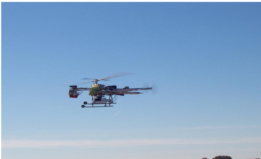
Рис. 6 Беспилотный вертолет MACS с 6-см СВЧ-радиометром на борту
