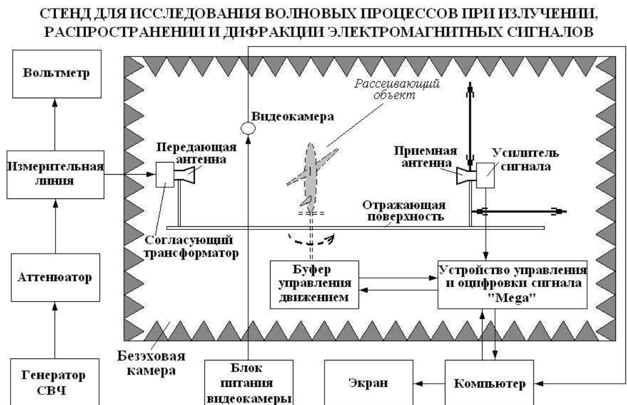
Рисунок 1 Структурная схема автоматизированного стенда
