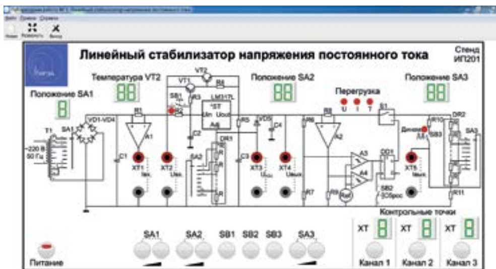
Рис. 4. Окно виртуальной передней панели лабораторного стенда ИП201.
