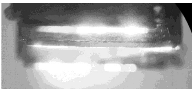
Рис.4. Ближняя зона излучения сборки, представленной на рис.3. Неоднородность свечения связана с пространственной неоднородностью распределения электронов накачки и разбросом параметров отдельных лазерных элементов.
