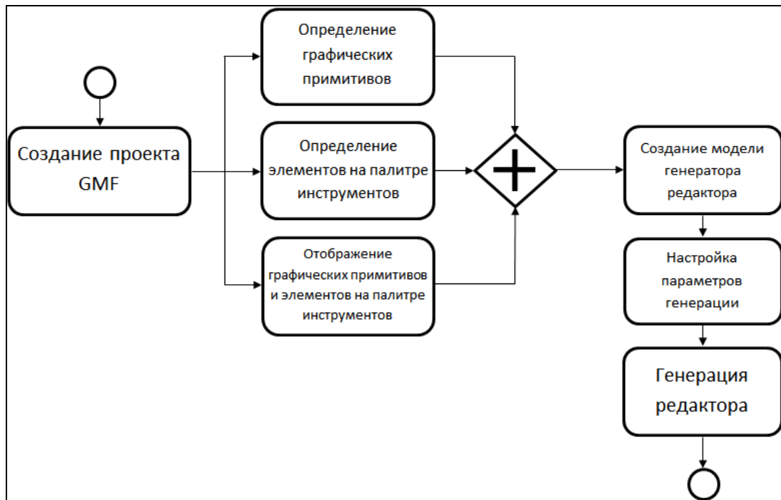
Рис. 3. Алгоритм генерации редактора предметно-ориентированного языка с помощью GMF
